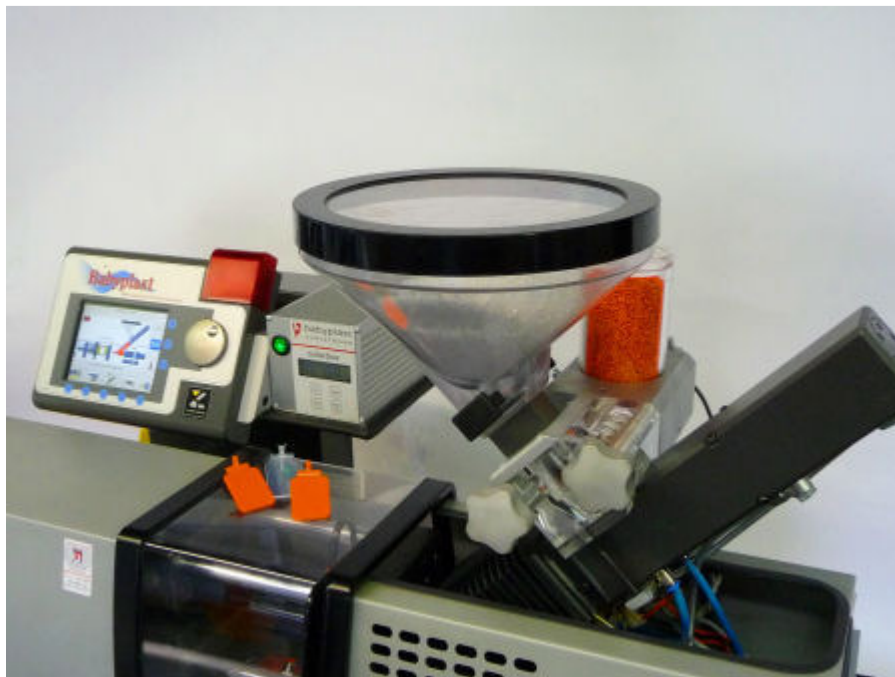
Einfärben mit babyplast: Neues Einfärbeaggregat für Master-Batch (Hauptkomponente + Farbbatch) - Bild: babyplast
