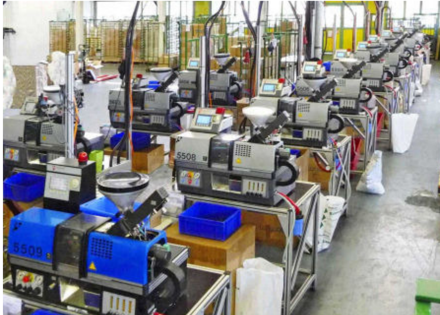
Präzision und Ausdauer: Fertigung von Kleinstteilen bei Geobra Brandstätter im Werk Dietenhofen (Playmobil) - Bild: babyplast
