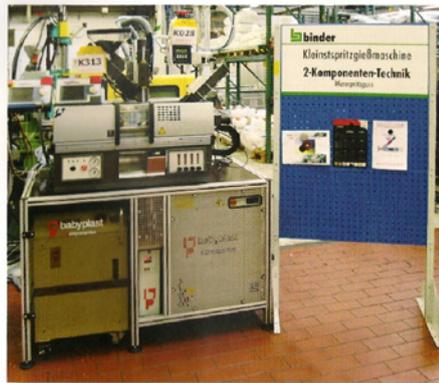
Komplettes Spritzaggregat mit Peripherieeinheiten.
