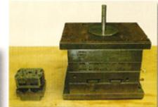
Links das 2K-Werkzeug mit 4 kg und rechts das Einkomponentenwerkzeug mit 90 kg.
