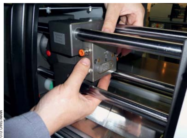
Flexible Werkzeugkonzepte: Handliche modulare Werkzeuge mit integrierten Formaufspannplatten bieten Effizienz und kompakte Abmessungen bis hin zur Heißkanaltechnik
