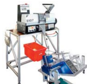
Konfektion nach Maß – Angussfrei in den Beutel: Babyplast-Fertigungszelle mit Beutelautomat
